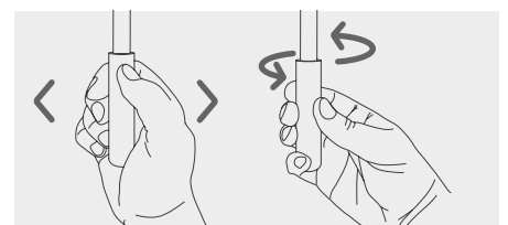
ASTINA DI MOVIMENTAZIONE Movimento orizzontale: apre e chiude la tenda Rotazione dell'asta: Movimenta le fasce verticali
